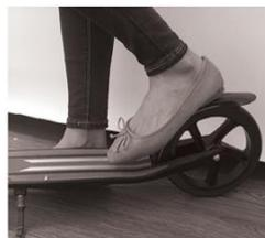
Pour s'arrêter plus rapidement, appuyez sur le frein à pied situé au-dessus de la roue arrière. Attention : A n'utiliser qu'en cas d'urgence !
