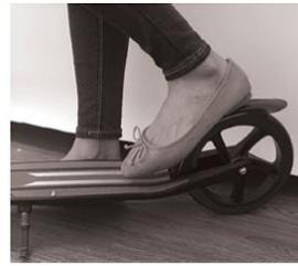
Um schneller anzuhalten, drücken Sie den Fuß auf die Fußbremse, die sich über dem Hinterrad befindet.
