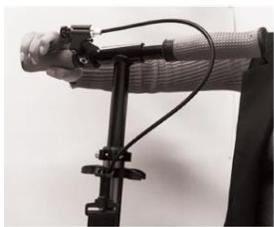
Azionare la leva del freno a mano tirandola nella direzione desiderata. Il freno a mano riduce la velocità senza arrestarsi improvvisamente.
