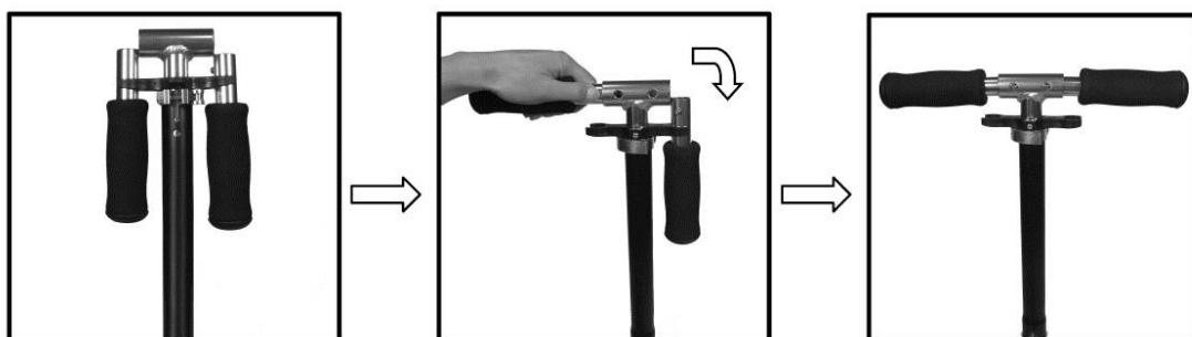
Távolítsa el a fogantyúkat a fogantyútartóról. A fogantyúkat a kormányba illessze be, amíg a zár be nem kattan. A fogantyúk igazításához az alsó fogókapcsot csavarozzuk ki. Miután hozzáigazítottuk az első kerékhez a fogantyúkat, utána vissza kell csavaroznunk a fogókapcsot.
