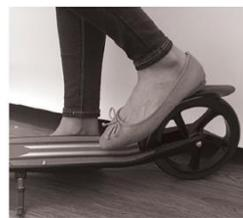
Per arrestarsi più velocemente, premere il pedale del freno situato sopra la ruota posteriore. Attenzione: Da utilizzare solo in caso di emergenza!
