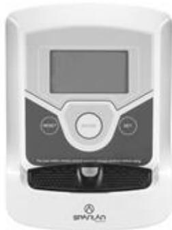
**COMPUTER:** Der Computer kann durch Drücken einer der drei Tasten aktiviert werden oder durch Treten. Wenn Sie das Gerät 4 Minuten lang nicht verwenden, wird die Die Computer Automatisch abschalten.
