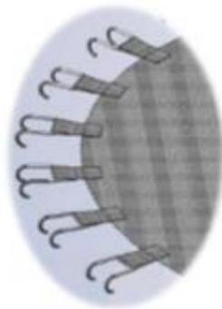
4. Fixieren Sie die Sprungmatte am Trampolinrahmen, passen Sie besonders auf, wenn Sie die Haken festmachen. Diese Verbindungsteile können zu Schwachpunkten werden wenn das Trampolin unter Spannung ist. Um Verletzungen oder Beschädigung zu vermeiden, muss die Sprungmatte wie unten gezeigt montiert werden.
