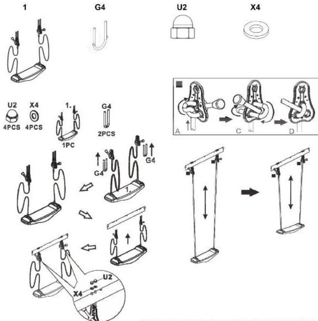
Hängen Sie 2 x Teil 1 an die U Schraube (G4), befestigen Sie dann die U Schraube am Oberen Stützrohr, befestigen Sie diese mit der Sicherheitsmutter U2 und der Beilagscheibe X4. Stellen Sie die Höhe so ein, dass der Sitz sich nicht höher als 400mm vom Boden befindet.
