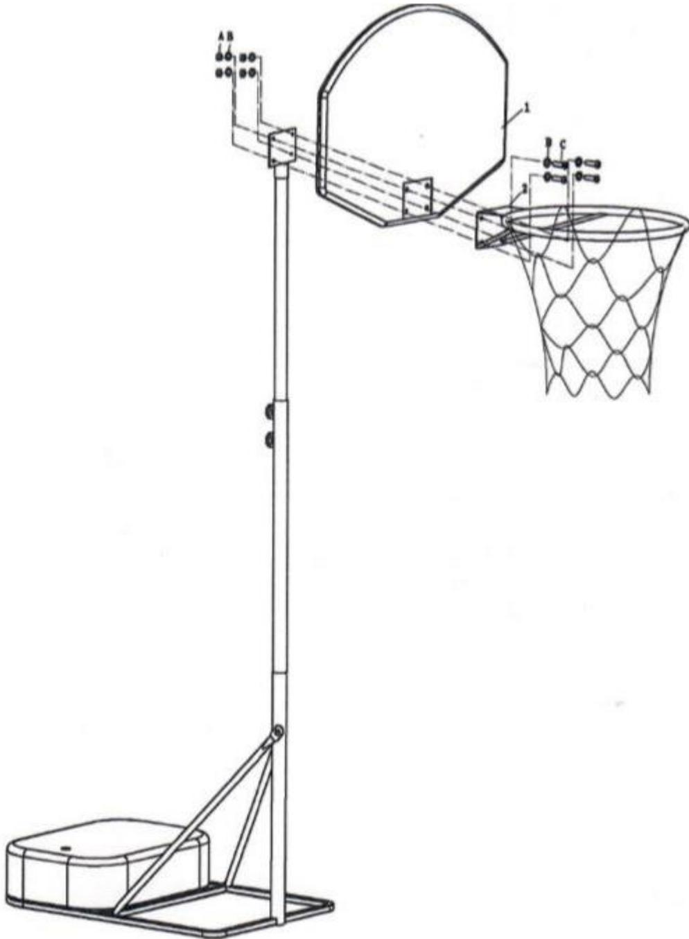
*4. Geben Sie die Ringplatte in die Aussparung vorne am Board. Befestigen Sie mit dem Schraube C und Sechskantmutter A und Beilagscheibe B.*
