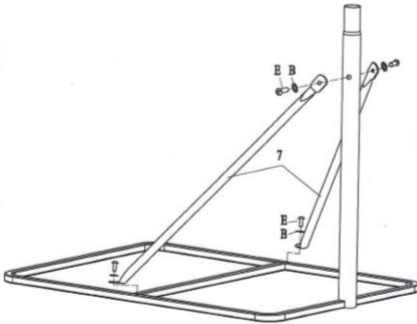
2. 1. Verbinden Sie die Basisrohre 7 dem unteren Rohr mittels Schraube E und Beilagscheibe B.
