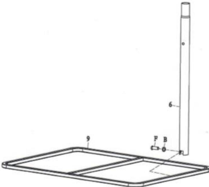
1. 1. Befestigen Sie das Unterrohr 6 mit Schraube F und Unterlegscheibe B im Basisrahmen 9.
