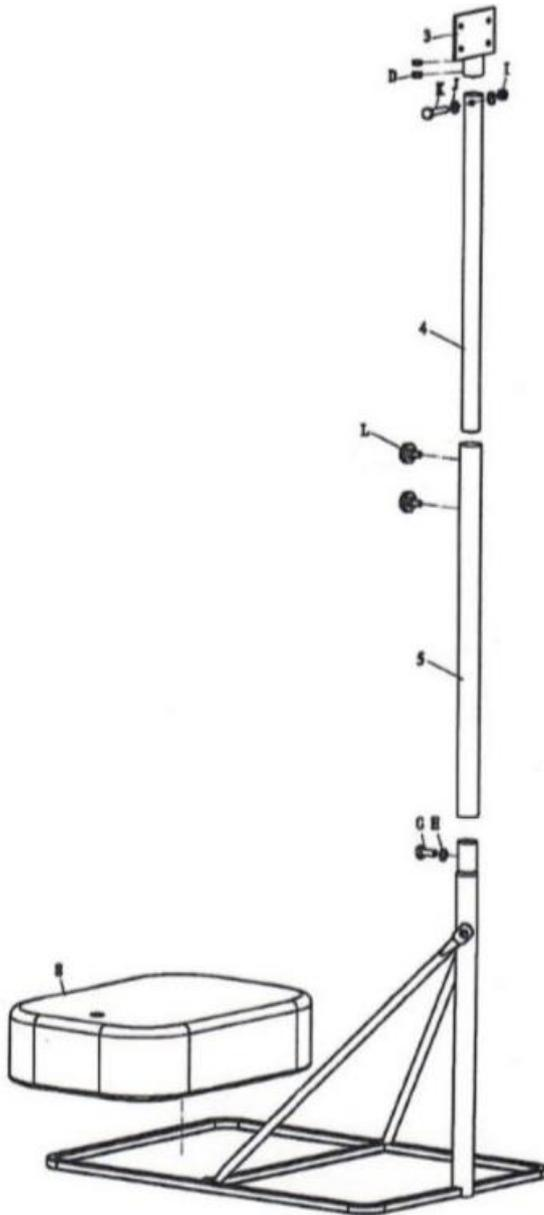
3. 1. Verbinden Sie das mittlere Rohr und das obere Rohr mittels Schraube L, G und Beilagscheibe E.
