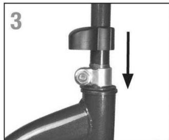
3. Schieben Sie die Abdeckkappe über die Lenkerstange. Danach schieben Sie die Lenkerklemme von oben auf den Gabelschaft. Achten Sie darauf, dass die Gabel vollständig an den Rahmenbuchsen anliegt. Stecken Sie den Lenker in den Gabelschaft (Mindeinstecktiefen-Markierung beachten) und verschrauben Sie die Lenkerklemme. Achten Sie darauf, dass der Lenker mittig klemmt und nicht verdreht werden kann.
