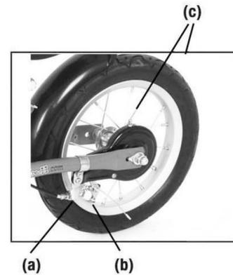
Achten Sie nach jeder Einstellung auf widerstandslosen Freilauf des Rades, da sonst die Bremse beschädigt werden kann.
