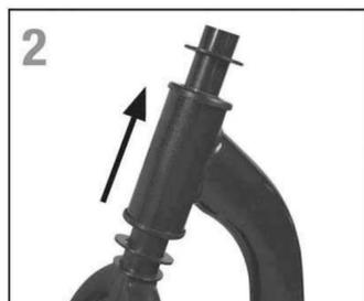
2. Schieben Sie die Gabel von unten durch den Rahmen, wie in der Abbildung gezeigt. Achten Sie darauf, dass sich je ein Kunststoffring über und unter dem Rahmen befindet.
