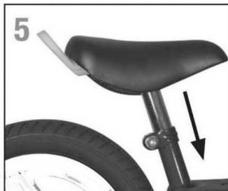
5. Stecken Sie den Sattel in das Sattelrohr. Beachten Sie die Mindestinstecktiefen-Markierung auf der Sattelstütze. Richten Sie den Sattel mittig aus und ziehen Sie die Klemmschelle fest.
