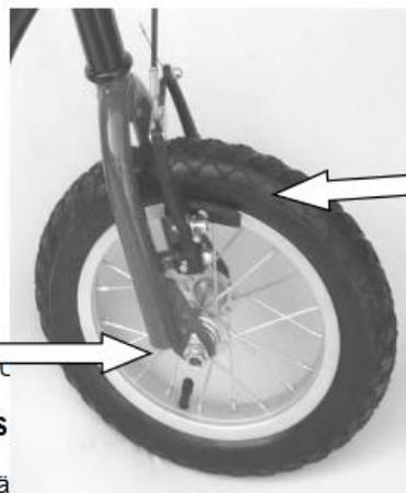
Die Gummiunterlage der Bremse sollte parallel zu dem Rand des Rades liegen und der Abstand zwischen Ihnen sollte zwischen 1,5-2mm haben
