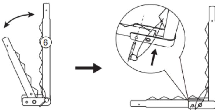
Klapprohr (6) Aufklappen und mit dem Sicherheitsstift befestigen.
