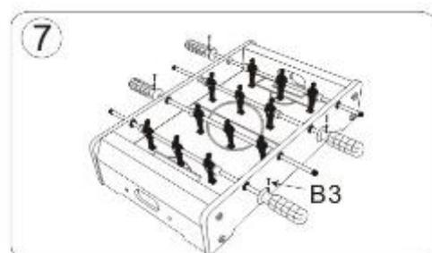
7 Setzen Sie 4 Schraube in die Griffe ein und schrauben Sie sie fest.
