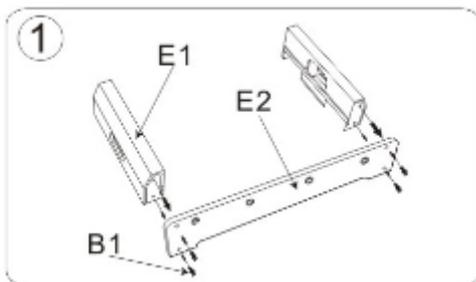
Montieren Sie zwei kurze und eine lange Seite mit schrauben fest.
