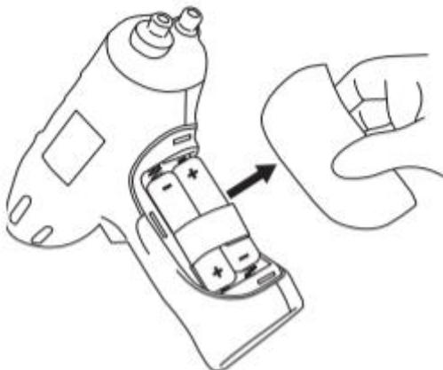
2. Halten Sie die beiden Enden des Farbbands fest und ziehen Sie die Batterien heraus. Legen Sie neue Batterien in dem Batteriefach ein und setzen Sie die Batterien wie oben beschrieben ein.
