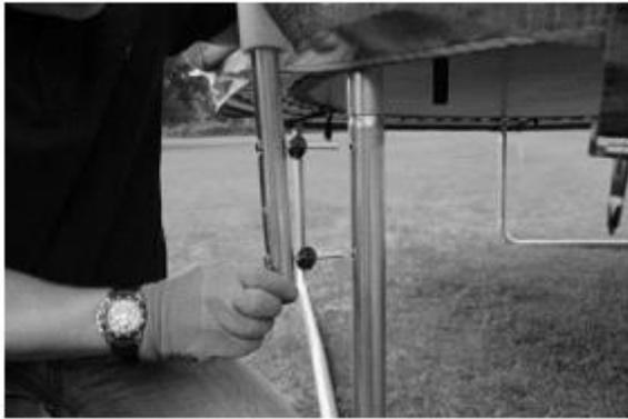
1. Setzen Sie 2 Schrauben durch die Löcher in der Unterseite der unteren Sicherheitsstange und setzen Sie dann die Gummibandschalter auf die Schrauben gemäß dem Bild links.
