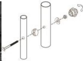
2. Bringen Sie die Sicherheitsnetzstange an ein Trampolinbein und führen Sie die Schrauben durch die entsprechenden Löcher am Trampolinbein. Halten Sie das Bein an Ort und Stelle und schrauben Sie die Muttern fest, um die Stange an Ort und Stelle zu halten. Stellen Sie sicher, dass die Stange sicher am Bein befestigt ist. Wiederholen Sie diesen Vorgang mit allen Stangen / Beinen des Trampolins.
